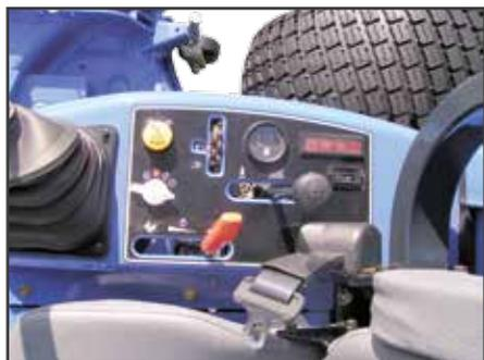
Sul lato destro del posto di guida sono posizionati in modo ben visibile ed ergonomico, tutti i principali comandi di guida e di lavoro
