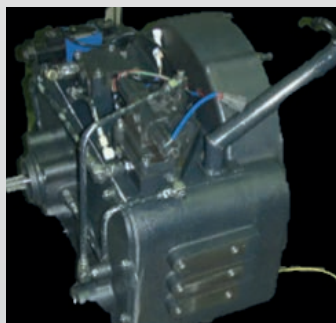
Riduttore meccanico della PTO con selezione „Power“ ed „Eco“.
