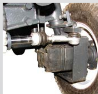
Trasm. posteriore completamente idraulica (Motore - Ruota)
