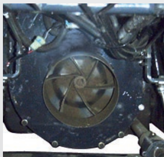
Turbina di aspirazione di elevata potenza, in acciaio
