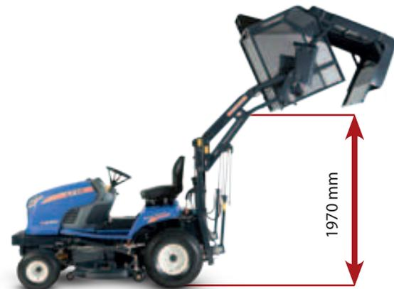
Il sollevatore idraulico per lo scarico rialzato permette di scaricare l'erba direttamente su un rimorchio o su un cassone, comodamente dal sedile dell'operatore. Il contenitore si solleva ad una altezza max. di 1.970 mm (Modello SXG 326).
