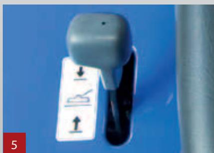
Leva di regolazione dell'abbassamento e sollevamento del piatto rasaerba (foto a sx) e il sollevamento del cesto di raccolta (scarico rialzato - foto dx)
