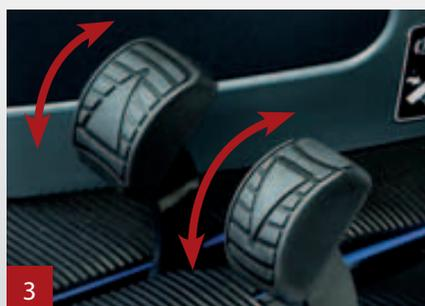
Controllo della trazione con 2 Pedali confortevoli arrotondati per aumentarne l'ergonomia.
