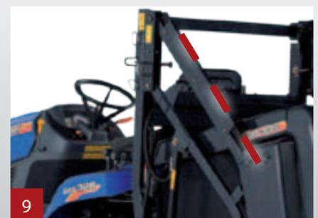
Protezione efficace e sicura contro ostacoli quali rami e cespugli: posizionamento interno al telaio dei tubi idraulici.
