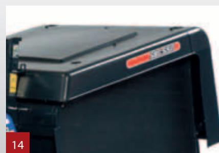
Il cesto di raccolta è chiuso ermeticamente nella parte superiore da una protezione antipolvere. L'operatore è completamente protetto dal pulviscolo creato dal flusso d'aria nel cesto di raccolta.
