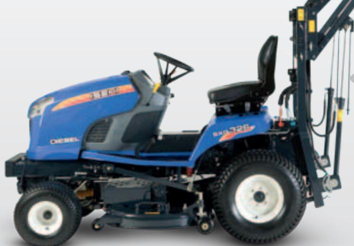
I cilindri idraulici (Soluzione con scarico rialzato) sono protetti dal danneggiamento possibile durante la manovra di svuotamento.
