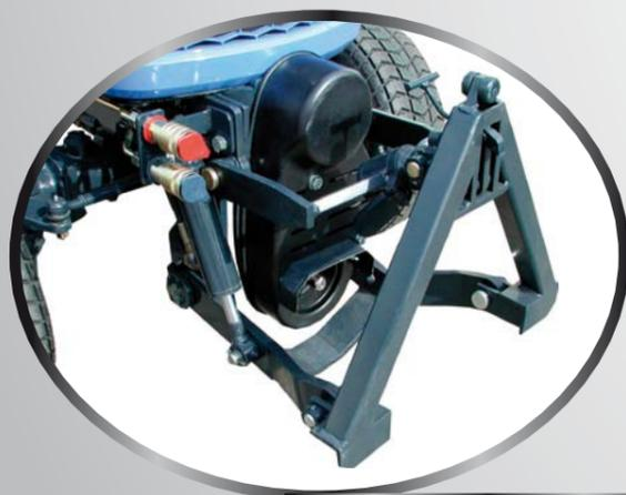
Nonostante le dimensioni ridotte, il TM3160 può essere equipaggiato con un potente sollevatore anteriore, prese idrauliche anteriori e PTO anteriore. E' disponibile un ampio ventaglio di attrezzi per sfruttare le sue indiscutibili doti di versatilità.
