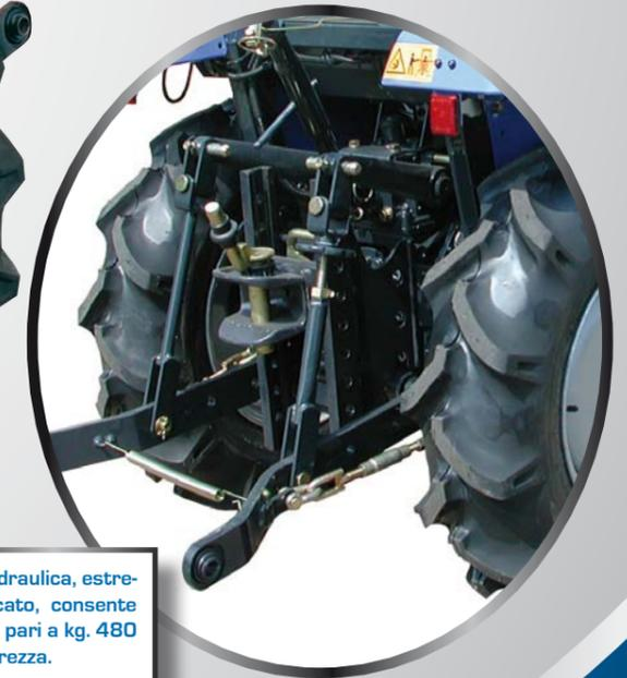
Un sistema a doppia pompa idraulica, estremamente potente e sofisticato, consente una capacità di sollevamento pari a kg. 480 in condizioni di massima sicurezza.
