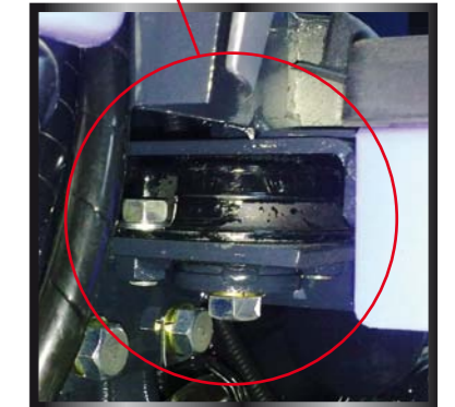
I nuovi trattori TH hanno la postazione di guida completamente flottante grazie ad un sistema di silent-blocks dedicati. Ciò contribuisce ad un maggior comfort dell'operatore, isolandolo dalle vibrazioni e riducendo i rumori.
