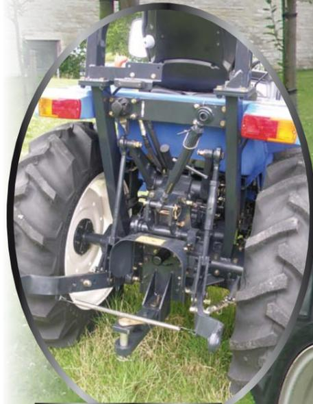
Il sollevatore posteriore ha una grande capacità di portata: ben 1.100 Kg alle rotule.
