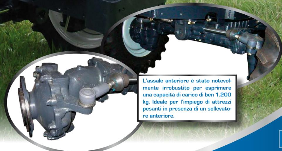
L'assale anteriore è stato notevolmente irrobustito per esprimere una capacità di carico di ben 1.200 kg. Ideale per l'impiego di attrezzi pesanti in presenza di un sollevatore anteriore.
