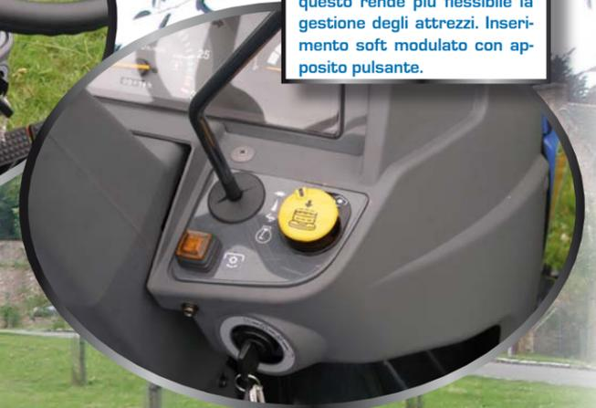
La presa di forza ad inserimento elettroidraulico è indipendente dalla trasmissione; questo rende più flessibile la gestione degli attrezzi. Inserimento soft modulato con apposito pulsante.
