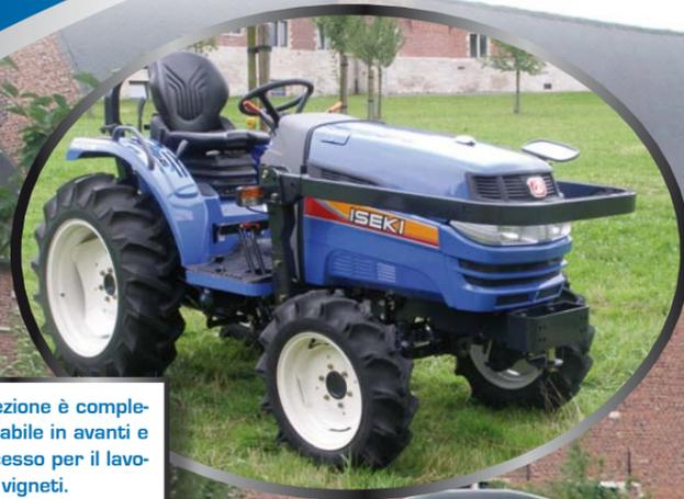
L'arco di protezione è completamente ribaltabile in avanti e permette l'accesso per il lavoro in frutteti e vigneti.
