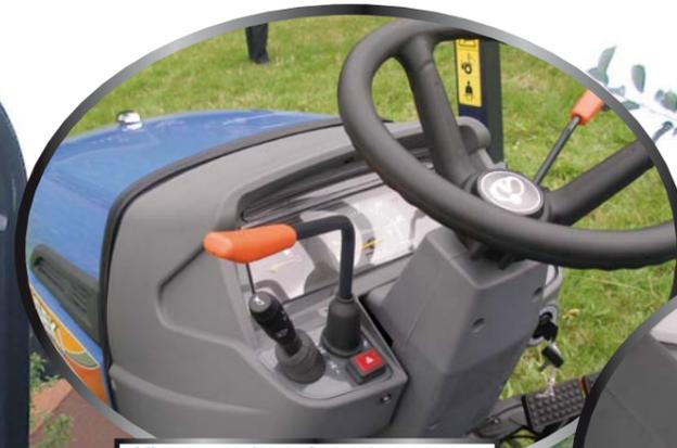
L'inversore sincronizzato è un notevole vantaggio operativo poiché permette all'operatore di invertire il senso di marcia senza arrestare completamente la macchina schiacciando la frizione.
