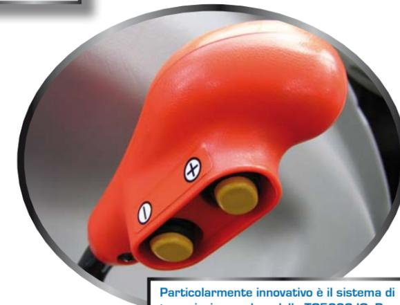
Particolarmente innovativo è il sistema di trasmissione sul modello TG5390 IQ. Per cambiare la marcia infatti, basta premere un pulsante con un dito sull'innovativo joystick per la gestione elettronica e sequenziale delle 4 marce di ciascuna gamma senza la necessità di utilizzare la frizione. Le 3 gamme di velocità non sono sincronizzate.
