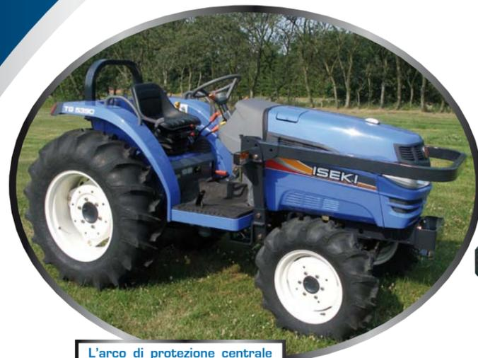
L'arco di protezione centrale è completamente ribaltabile in avanti e permette l'accesso per il lavoro in frutteti e vigneti (solo versione TG5390M). Per il modello TG5390IQ l'arco di protezione è posteriore e ribaltabile.
