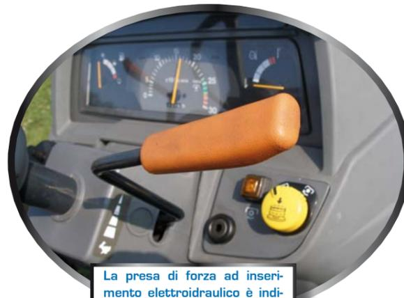
La presa di forza ad inserimento elettroidraulico è indipendente dalla trasmissione; questo rende più flessibile la gestione degli attrezzi. Innesco PTO con interruttore che consente anche la modalità SOFT.
