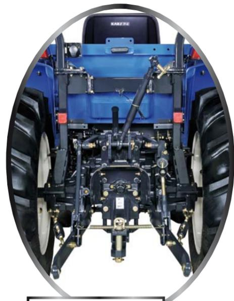
Il sollevatore posteriore ha una grande capacità di portata: ben 1.270 Kg alle rotule.
